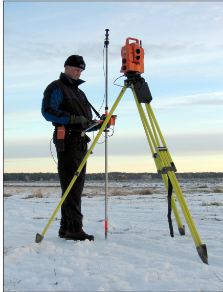
Kuva 1. Salaojasuunnittelija kartoittaa pellon takymetrillä ja tekee suunnitelman mittausten perusteella.
