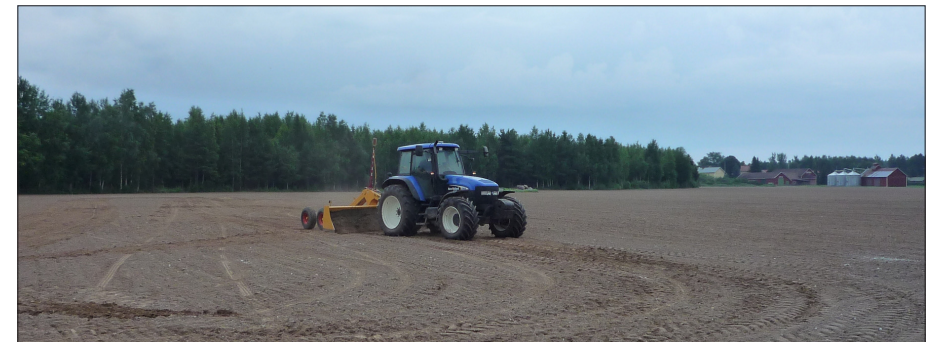
Kuva 1. Peltoa muotoiltiin laserohjatulla taseuslanalla.
