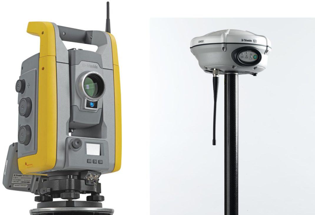
Kuva 13. Kuvassa vasemmalla on takymetri ja oikealla satelliittipaikannin.
