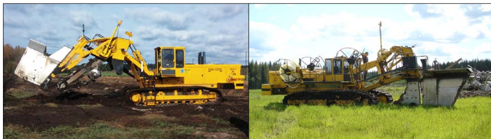
Grävande och plogande täckdikningsmaskin.
