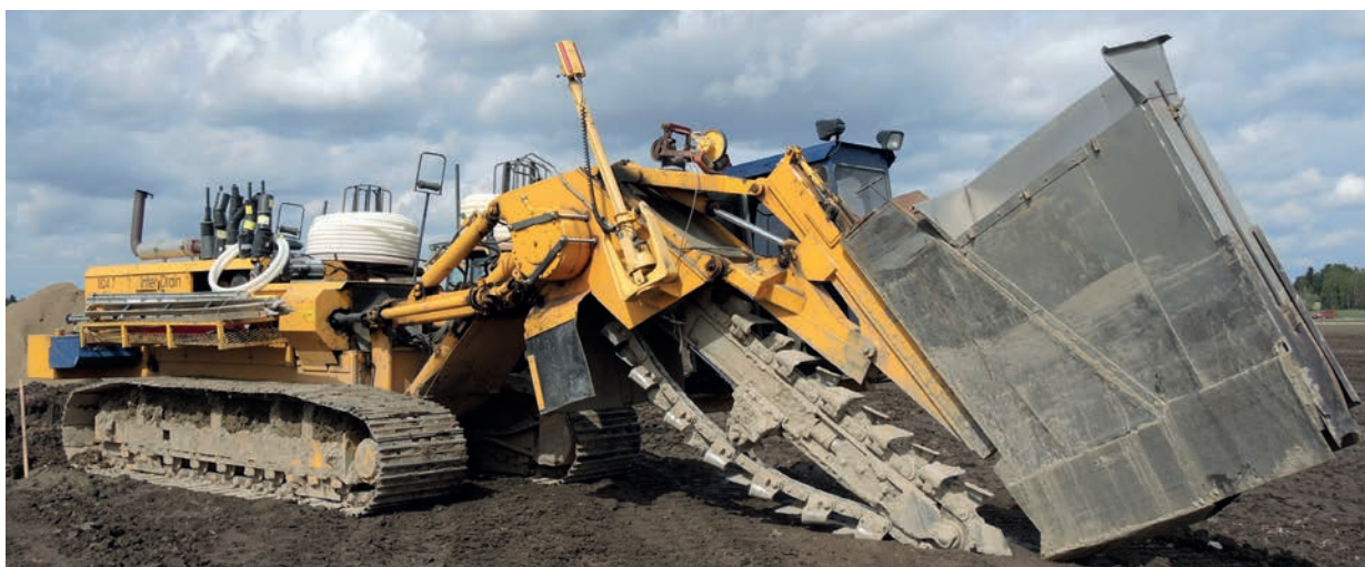
Kuva 2.4. Kaivava kone Inter-Drain 1824T.
