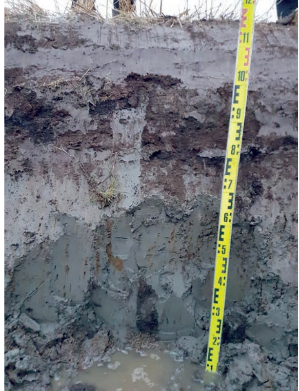
Kuva 3.41. Huonosti muodostunut salaojakaivanto, jossa ei ollut ruokamultaa eikä vettä hyvin läpäisevää materiaalia, Isokyrö.
