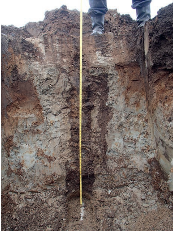
Kuva 3.40. Hyvin muodostunut salaojakaivanto, jossa ruokamultaa oli putken ja soran päältä pellon pintaan asti, Sievi 3.
