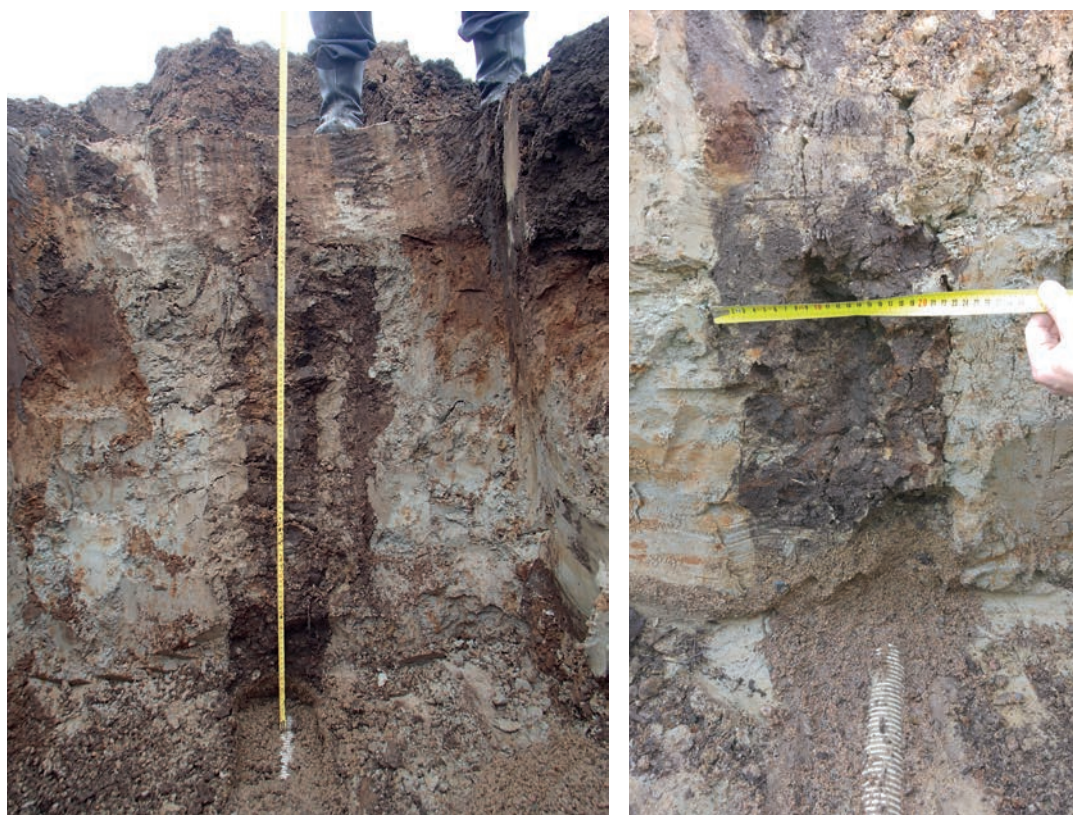
Kuva 3.28. Salaojakaivannon rakenne oli hyvä aurakoneella (vas.) ja kaivavalla koneella (oik.) tehdyissä ojituksissa Sievin koekentällä. Kaivannot aukaistiin noin neljä kuukautta ojituksen jälkeen.
