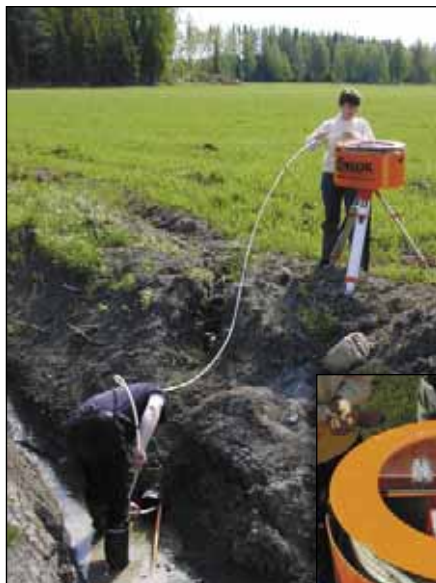
Figur 8. Avvägningsinstrumentet grundar sig på mätning av tryckskillnader. Noggrannheten är 2 mm.
