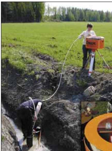
Kuva 8. Asennustarkkuusmittarin toiminta perustuu paine-eron mittaamiseen, valmistaja takaa 2 mm:n mittaustarkkuuden.
