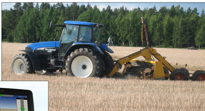
Kuva 2 GPS- ja lasertekniikoista huolimatta tasaus vaatii vielä tässä vaiheessa käsin laskentaa ja huolellista työnjäljen seurantaa.
