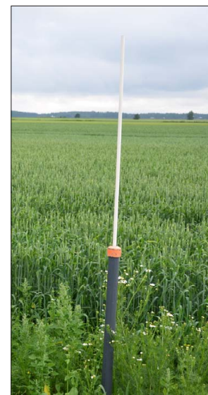
Kuva 3. Pohjavesiputken kelluva antenni näyttää pohjaveden pinnan etäisyyden maanpinnasta (Kuva: Rainer Rosendahl.)
