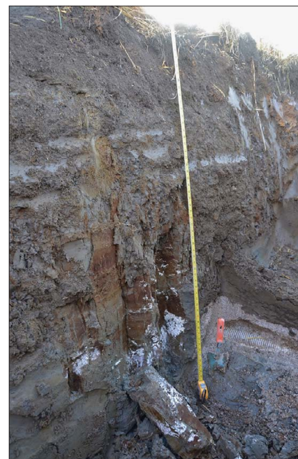
Kuva 2. Kalsiumkarbonaattisuspension tunkeutuminen maahan alhaalla oikealla näkyvästä salaojaputkesta. (Kuva: Rainer Rosendahl.)
