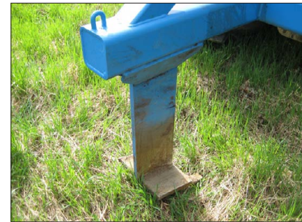
Kuva 6. Sotkamon koekentän jankkurointikokeessa käytetty jankkuri. (Kuva: Merja Mylly.)
