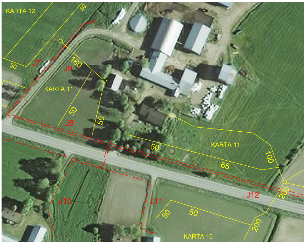
Bild 2. Exempel på en karta som ritats av en täckdikningsplanerare, där han har ritat in alternativa placeringar för linjen samt placeringen av täckdiken, brunnar osv samt rördimensioner. För grävarbetena ritas en separat karta, men en karta över täckdiken och planerad linjedragning som lagts ovanpå en flygkarta ger mycket bra information både för jordägaren och för den som ansvarar för gräventreprenaden. Bild: Rainer Rosendahl
