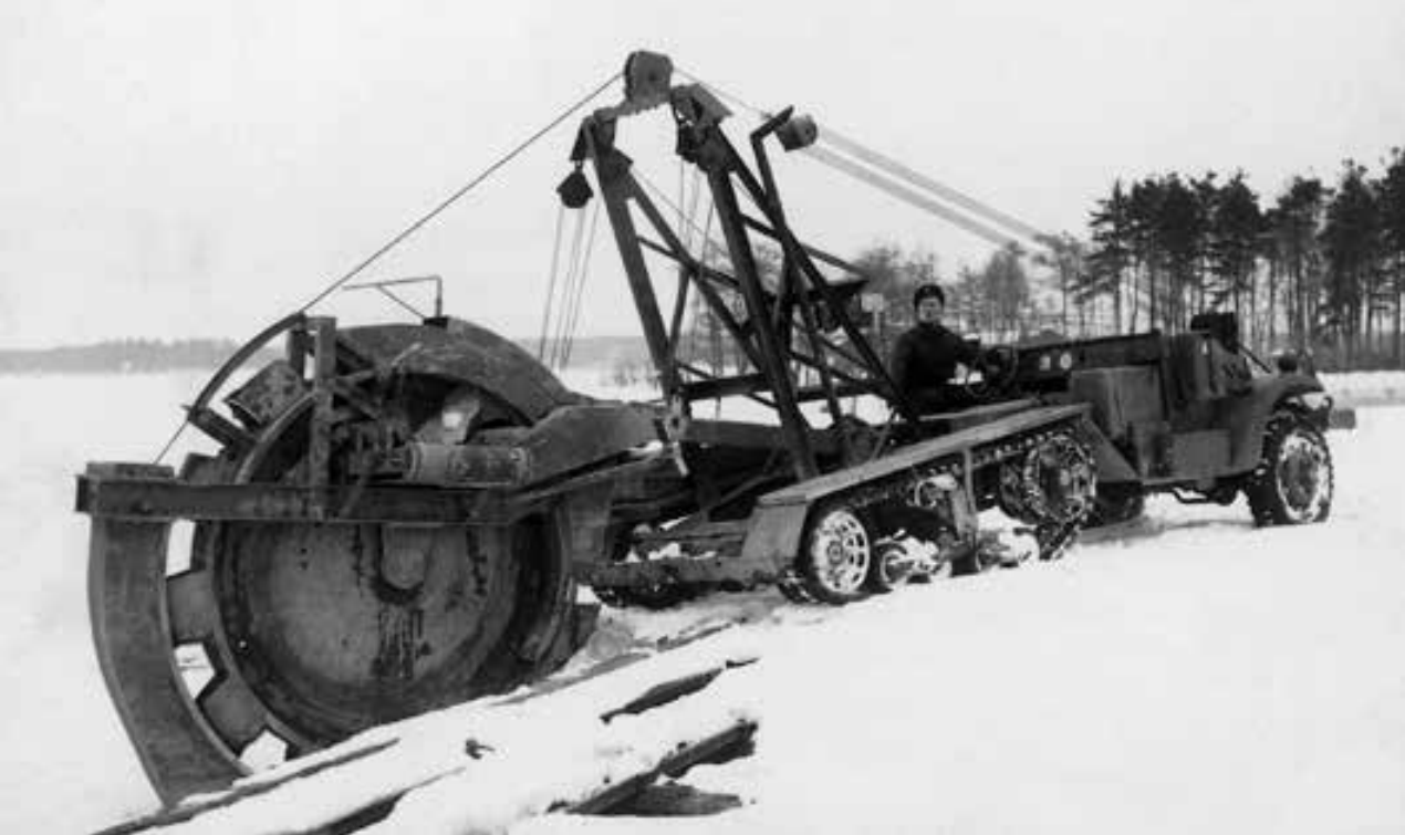
”Santahaminalaisen” syvyydensäätö toimi aluksi pelkillä vaijereilla.
