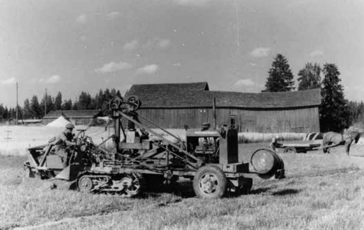
Amerikkalaisia salaojakoneita hankittiin sodan jälkeen Suomeen. Kuvassa Pellonraivaus Oy:n Buckeye.
