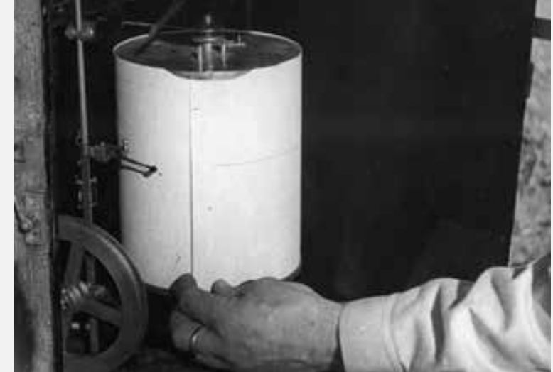
Automaattinen salaojaveden mittari eli jousikäyttöinen limnigrafi.
