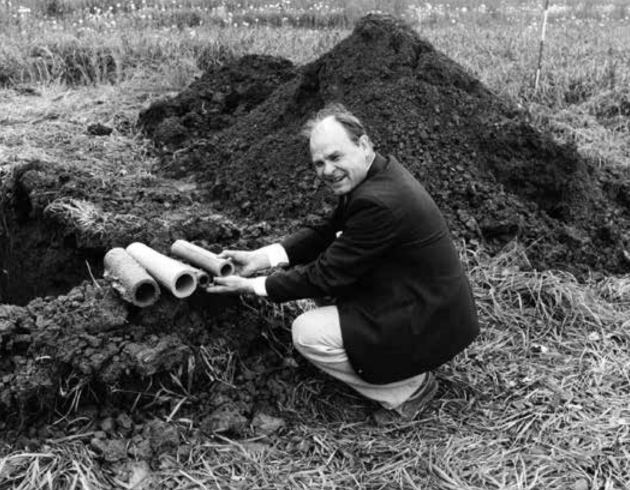
Jussi Saavalainen vertailemassa uusia ja 125-vuotiaita tiiliputkia.
