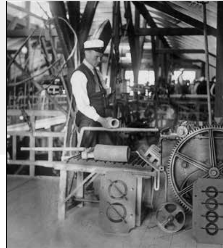
Käsinväännettävä putkipuristin Mustialassa.
