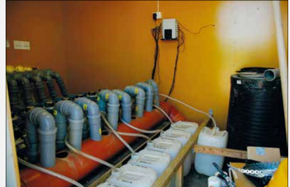
Mittalaitteistoa PVO- hankkeen salaojituskentällä Jokioisilla. Neljältä osa-alueelta mitattiin vuosina 2007–2013 salaoja- ja pintavaluntaa jatkuvatoimisesti ja kokoomanäytteitä otettiin valuntaan suhteutettuna vesianalyysjä varten.
