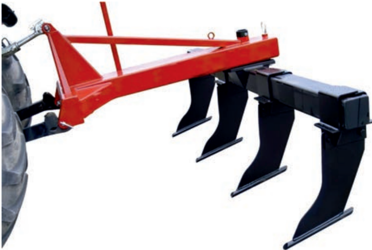
Jankkuroinnilla eli mekaanisella kuohkeutuksella rikotaan tiivistymiä.
