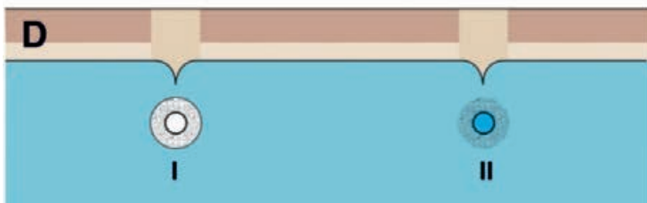
D) Laskuaukko on veden alla, putki tai ympärysaine on tukossa tai putken reiät ovat tukossa.
