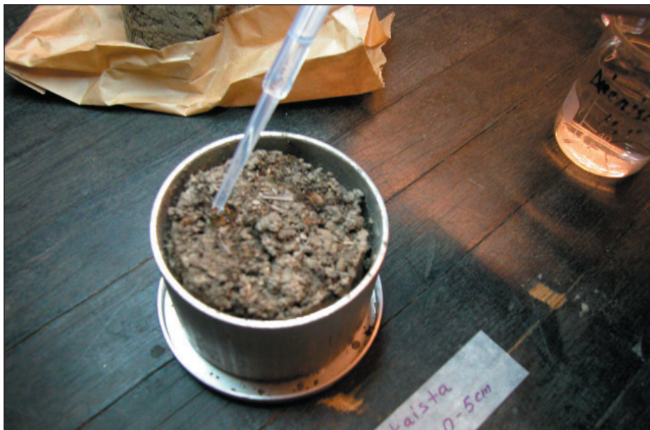
Kuva 4 Vedenhylkivyyden mittaus vesipisaran pudotustestillä, jossa mitattiin pisaran imeytymisaika.
