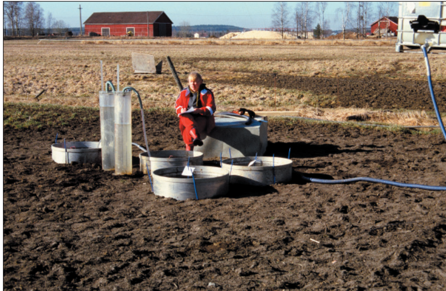
Kuva 3 Veden imeytymismittaukset käynnissä Nummelan savimaan juomapaikalla huhtikuussa 2002.
