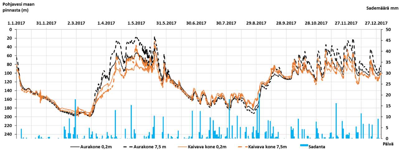
Kuva 27. Pohjaveden pinnankorkeudet (jatkuva mittaus, mittausintervalli 10 min) 0,2 – ja 7,5 m etäisyyksillä salaojasta aurasalaojakoneella ja kaivavalla koneella. Sadanta (vesi, korjaamaton) on esitetty viikkoarvoina.
