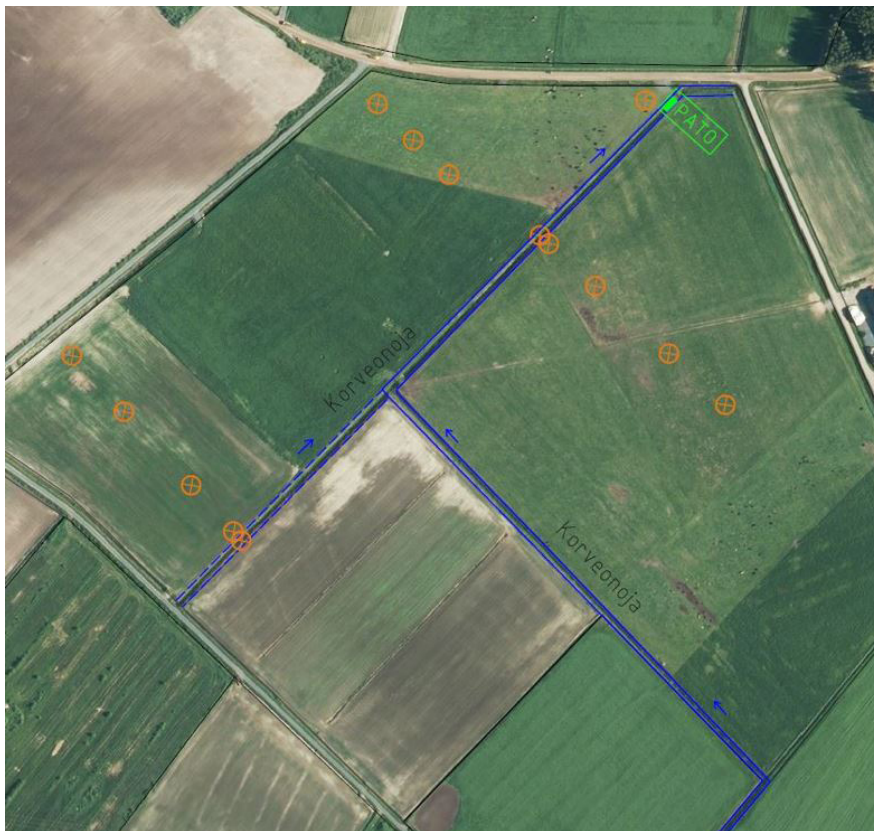
Kuva 2.11. Sievin Järvikylän Korvenoja. Säätöpato on kuvan oikeassa yläkulmassa. Pohjavesiputkien sijainti on merkitty oransseilla ympyröillä.
