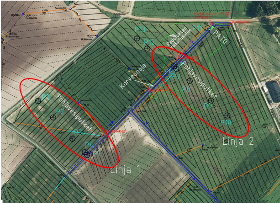
Kuva 2.13. Valtaojan padotusalue ja pohjavesiputkilinjat 1 ja 2.
