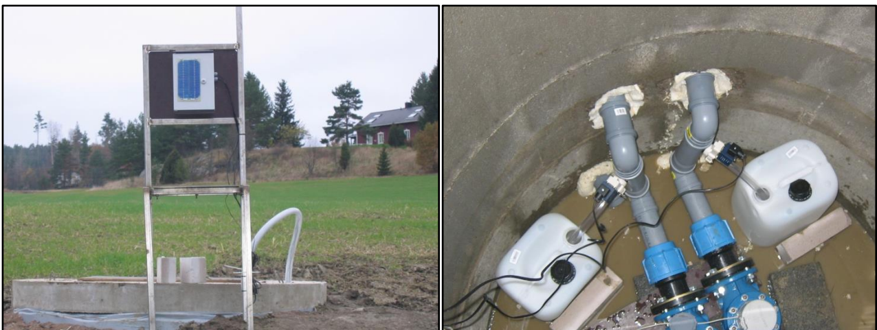
Kuva 2.4 Alueen 2 mittauskaivo ja dataloggeri (vas.) sekä mittauslaitteet kaivossa (oik.).
