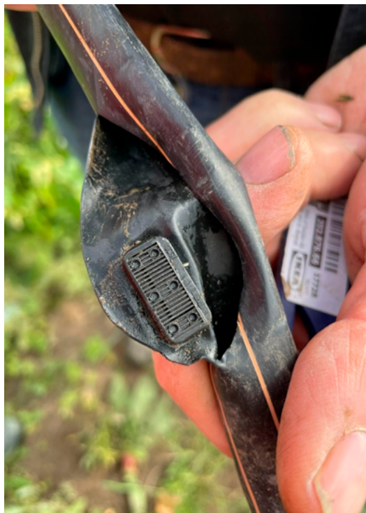
Kuva 6.5. Tihkukasteluletku kuvattuna tihkun kohdalta letkun ulko- ja sisäpuolelta. Kasteluveden riittävä suodattaminen on tärkeää tihkujen tukkeutumisen estämiseksi. Virtauksentasajaan tarkoitus on tasata tihkukohtien virtausta, jotta kastelu olisi mahdollisimman tasainen paineen muuttuessa putkessa. (Kuva: Lantbrukarnas Riksförbund (LRF).)
