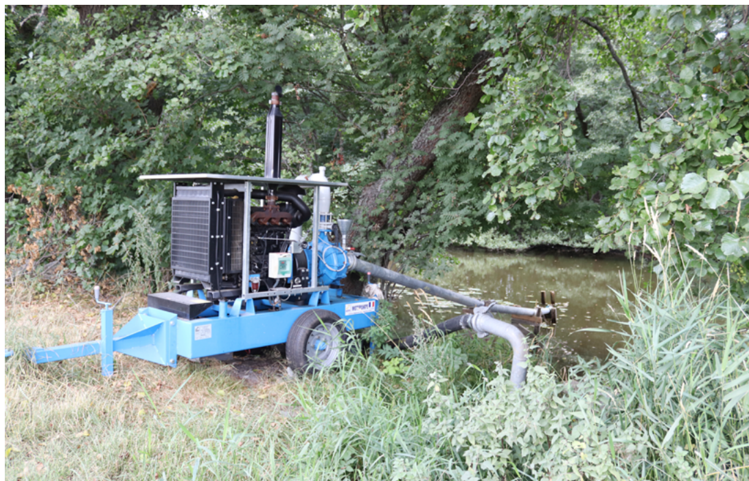
Kuva 7.1. Polttomoottoripumppu kasteluveden pumppaamiseen joesta sadetusta varten. Pikkalan kartano, Siuntio. (Kuva: Jani Bergholm.)
