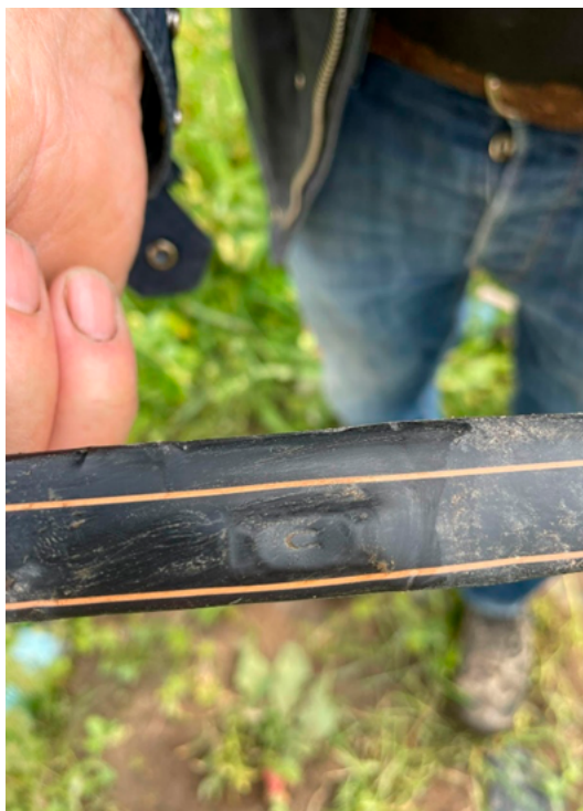
Kuva 6.5. Tihkukasteluletku kuvattuna tihkun kohdalta letkun ulko- ja sisäpuolelta. Kasteluveden riittävä suodattaminen on tärkeää tihkujen tukkeutumisen estämiseksi. Virtauksentasajaan tarkoitus on tasata tihkukohtien virtausta, jotta kastelu olisi mahdollisimman tasainen paineen muuttuessa putkessa. (Kuva: Lantbrukarnas Riksförbund (LRF).)
