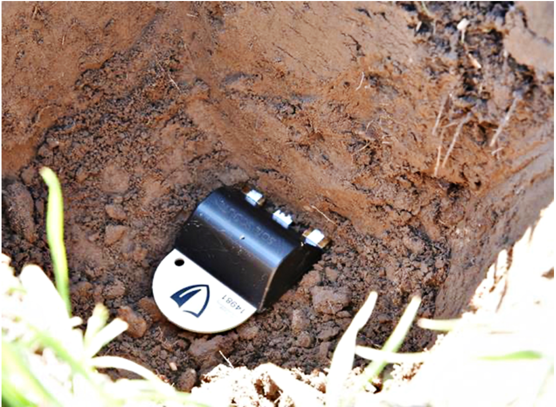
Kuva 3.1. Useiksi vuosiksi maahan asennettavat ja langattomat maan kosteutta mittaavat anturit voidaan asentaa pareittain maaperän eri kerroksiin. Antureilla voi saada myös tiedot maan suolaisuudesta ja lämpötilasta. (Kuva: Markku Pulkkinen.)
