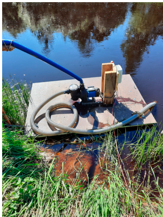
Kuva 7.2. a) Aurinkokennotoiminen pumppu ja b) virtalähteenä toimiva aurinkopaneeli. Pumppu on asennettu lautalle, koska joen vedenpinnan korkeuden vaihtelut ovat suuria ja laitetoimittajan suositus kyseiselle pumpulle on, että imuletku olisi mahdollisimman lyhyt. Aurinkokennotoimisen pumpun virranlähteenä toimiva aurinkopaneeli on asennettu joen penkalle. Aurinkoenergiaa on usein eniten saatavilla, kun kastelun tarve on suurin. (Kuvat: Minna Mäkelä.)
