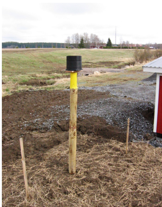
Kuva 3.2. Sademittari. Sadantaa kannattaa mitata tilalla sateiden paikallisuuden vuoksi. (Kuva: Salaojajhdistys ry.)
