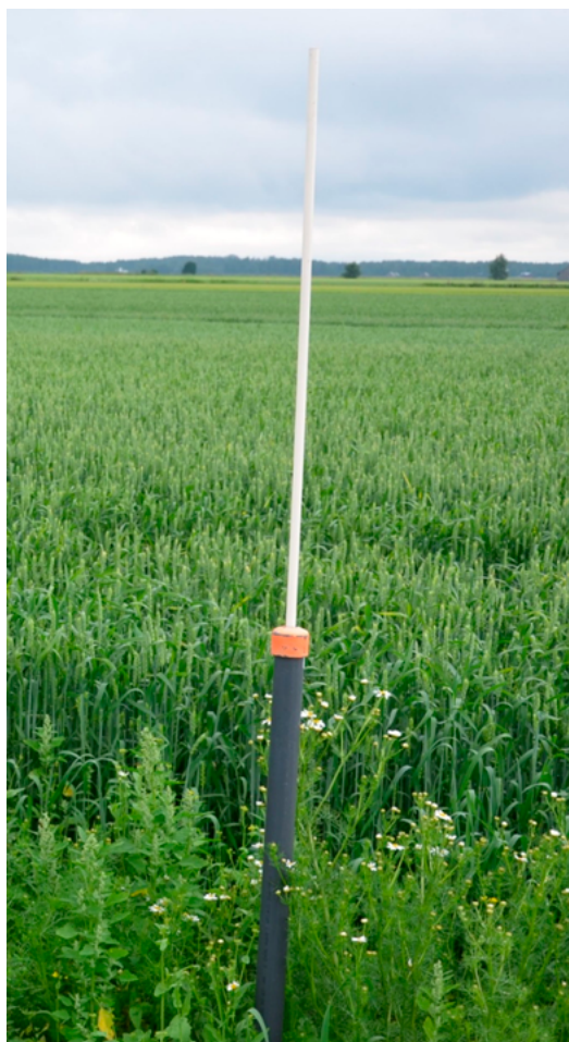
Kuva 6.4. Pohjavedenpinnan tasoa voi mitata pohjavesiputkeen asennettavalla ja kohon avulla toimivalla niin sanotulla antennilla, joka näyttää pohjavedenpinnan etäisyyden maanpinnasta. Pohjavedenpinnan tason mittaamiseen on myös olemassa automaattimittareita. (Kuva: Rainer Rosendahl.)
