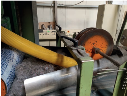
Kuva 2. Salaojaputken esipäälystämisen synteettisillä kuiduilla. Vasemmanpuoleisen kuvan vasemmassa alanurkassa näkyy esipäälystämateriaali. Esipäälystettyjen salaojaputkien käyttö on Saksassa yleisempää kuin Suomessa. (kuvat: Olle Häggblom)
