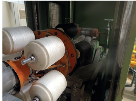
Kuva 2. Salaojaputken esipäälystämisen synteettisillä kuiduilla. Vasemmanpuoleisen kuvan vasemmassa alanurkassa näkyy esipäälystämateriaali. Esipäälystettyjen salaojaputkien käyttö on Saksassa yleisempää kuin Suomessa. (kuvat: Olle Häggblom)
