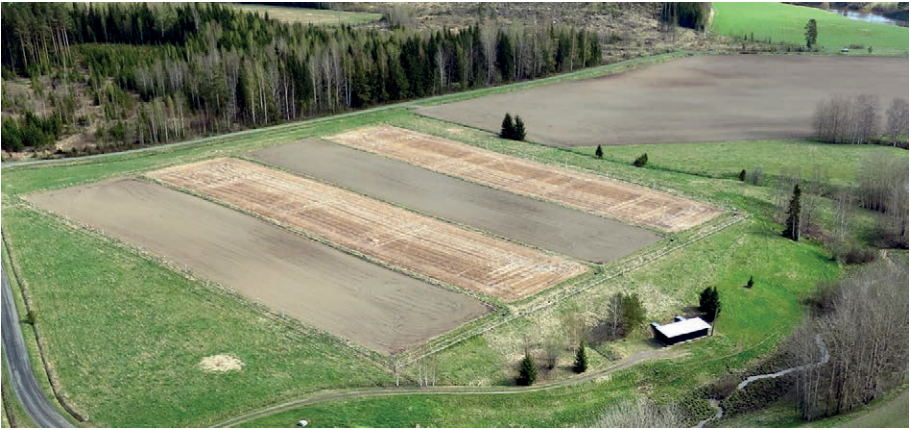
Kuva 2. Vuonna 1975 aitosavimaille perustettu Kotkanojan koekenttä on jaettu neljään 0,5 hehtaarin kaistaan. Kaistat on edelleen jaettu neljään salaojaruutuun, joilta poistuvien salaojavesien määrä mitataan jatkuvasti. Vesistä kerätään valumaan suhteutettuja näytteitä ravinnemääriksiin. Tällä hetkellä kaksi kaistaa kynnetään vuosittain ja kaksi on suorakylvettyä. Kastelieroistutus tehtiin kentän metsänpuoleiseen laitaan. Kuva: Jaakko Heikkinen, Luke
