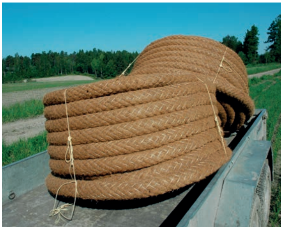
Kuva 14. Kookoskuidulla esipäälystettyä salaojaputkea. Kuitupäälysteen paksuus maahan asennettuna on 3 mm. Kuva: Helena Äijö.
