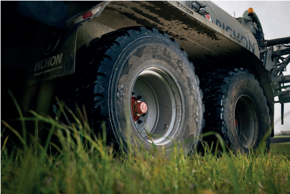
Kuva 21. Riittävän suuret matalapainerenkaat auttavat ehkäisemään peltomaan tiivistymistä. VF-renkaat mahdollistavat pienempien rengaspaineiden käytön myös maantienopeuksissa. Kuva: Nokian Renkaat.
